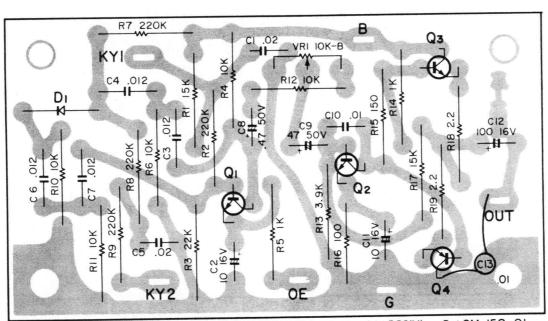
Q1:2SC733(Y)or(GR), Q2:2SC734(Y), Q3:2SC735(Y), Q4:2SA562(Y), D1:SM-I5O-OI
