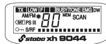
Hier worden alle functies weergegeven. De geblokte lijnweergave onder in het display geeft het ontvangstniveau en de sterkte van het uitgezonden signaal.
