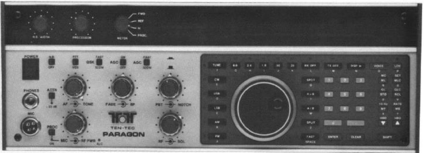
FIGURE 3-3. MODEL 585 FRONT PANEL
