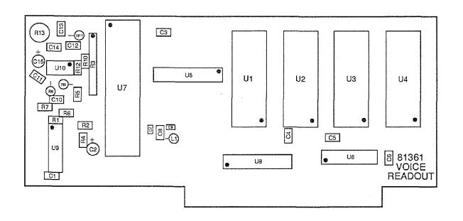
FIGURE 6-66. 81361 VOICE READOUT BOARD COMPONENT LAYOUT
