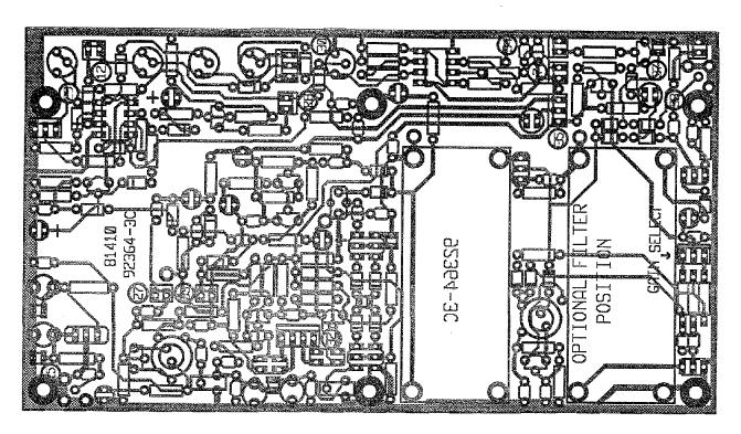
FIGURE 6-11. 81410 9 MHZ CRYSTAL FILTER CIRCUIT TRACE
