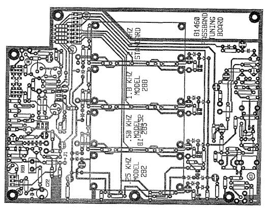
FIGURE 6-14. 81460 PASS BAND TUNING BOARD CIRCUIT TRACE
