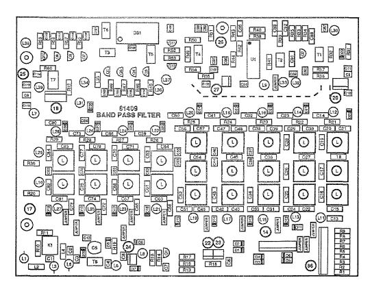
FIGURE 6-6. 81409 BAND PASS FILTER COMPONENT LAYOUT
