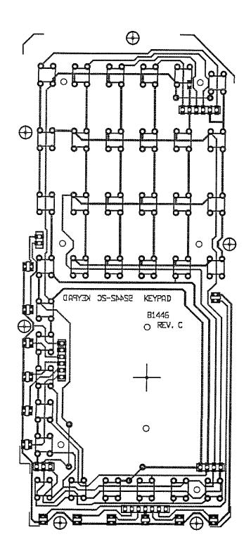
FIGURE 6-53. 81446 KEYPAD BOARD CIRCUIT TRACE
