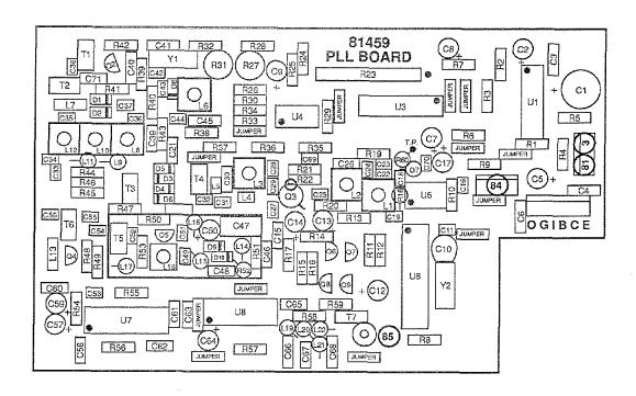
FIGURE 6-22. 81459 5.0-5.5 MHZ PLL BOARD COMPONENT LAYOUT
