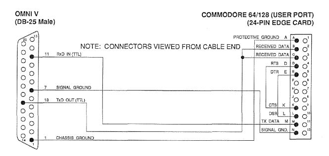
FIGURE 5-10C. COMMODORE 64/128 RS232 CONNECTOR CABLE
