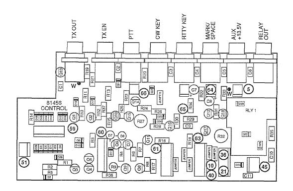
FIGURE 6-25. 81456 CONTROL BOARD COMPONENT LAYOUT
