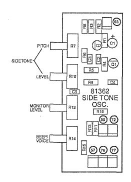
FIGURE 6-37. 81362 SIDETONE BOARD COMPONENT LAYOUT
