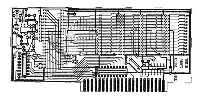
FIGURE 6-65. 81361 VOICE READOUT BOARD CIRCUIT TRACE
