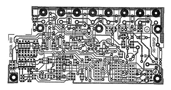
FIGURE 6-24. 81456 CONTROL BOARD CIRCUIT TRACE
